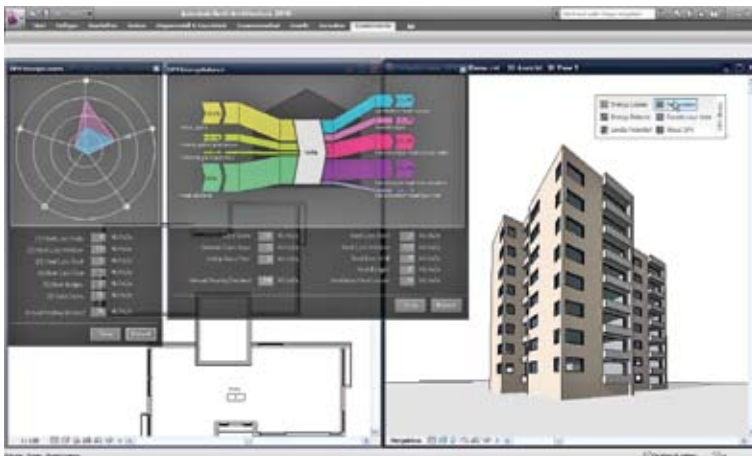
Die Berechnungsergebnisse werden anschaulich visualisiert und sind dadurch für den Architekten und Planer leicht interpretierbar
